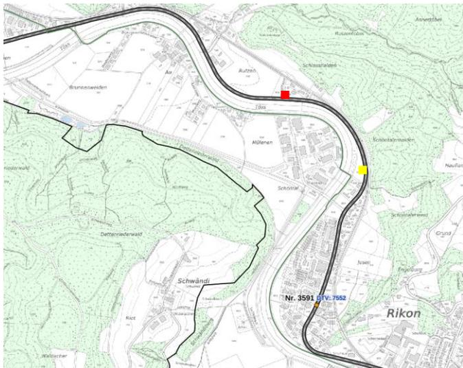
**Abbildung :** Übersicht Standort Verkehrszähler und Kameras (rotes und gelbes Quadrat) der Messstelle, Tösstalstrasse in Zell
